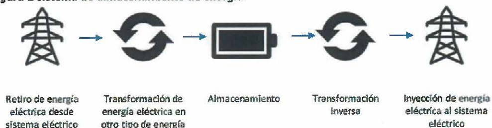
Figura 1 Sistema de almacenamiento de energía
